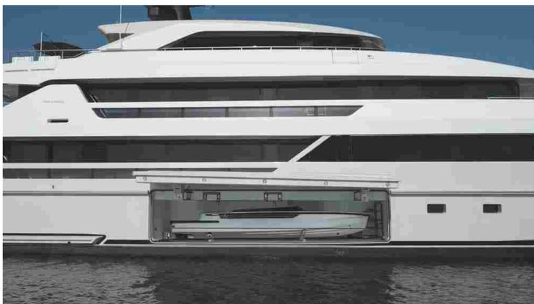
Per liberare completamente lo spazio della beach area, il 62Steel è stato disegnato con due garage con accesso da aperture laterali, a mezza nave, che contengono a dritta il tender principale di 9 metri e a sinistra il tender di servizio e la moto d’acqua.
